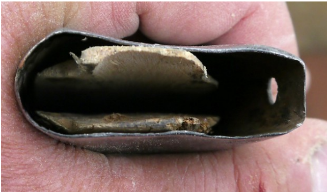
Fourreau An 9, tôle fine de 0,9 mm déformée , à noter les 2 alèses
